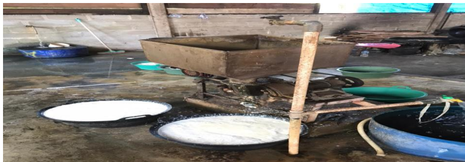
Gambar 2. Kedelai dihancurkan dengan mesin penggiling hingga menjadi bubur.
