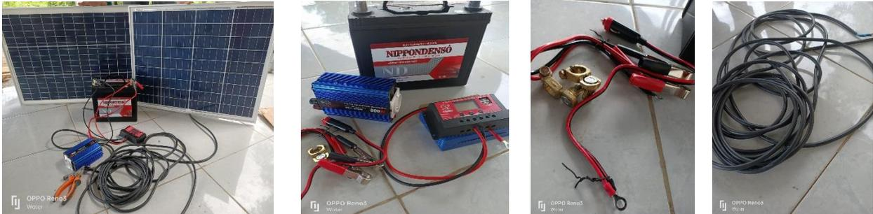
**Gambar 1. Komponen alat pembangkit listrik tenaga surya**
